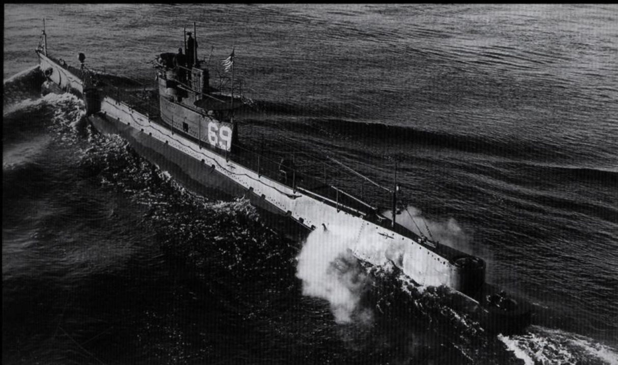
「69」のナンバーが見えるので、1917年12月3日に進水したO-8である。第2次大戦中に訓練用として使用されている際のショットで、軽対空火器用の砲座が増設されているのが確認できる。独特の艦尾構造に注目されたい。
